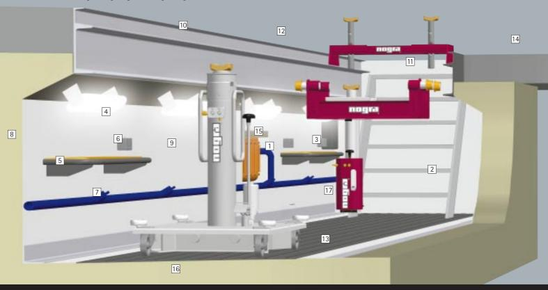
Länge Sie ist frei wählbar. Ideal sind ca. 21 m. Von einem langen Fahrzeug sollten niemals gleichzeitig beide Grubenzugänge versperrt sein.
