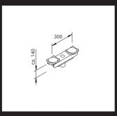
TK Achstraverse zur sicheren Aufnahme schwerster Fahrzeuge. Die kurze Ausführung gewährleistet eine weitestgehend zentrische Lastverteilung.
