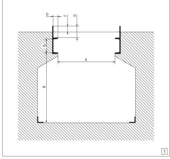
Maßblatt für Grubenfahrwerke und Abstützsysteme Nach diesem Maßblatt fertigen wir Ihr Grubenfahrwerk bzw. Ihre Abstützbrücke. Bitte gehen Sie bei der Ermittlung dieser Abmessungen sorgfältig vor. Besonders das Grubenmaß A ist von großer Bedeutung. Bitte prüfen Sie, ob dieser Abstand über die gesamte Grubenlänge identisch ist. Wenn dies nicht der Fall sein sollte, geben Sie bitte das Größt- und Kleinstmaß an (Bitte an mehreren Stellen messen).
