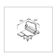
GP 2000 Mit einem Verstellwinkel von rundum  $\pm$  15 $^{\circ}$ über Schrauben läßt sich das Aggregat mühelos über Hindernisse hinwegheben. Spanngurte dienen zur
