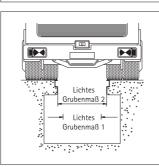
Beispiel Die unterschiedlichen Grubeneinfassungen führen zu einem unterschiedlichen lichten Grubenmaß. Die Spurbreite des Lkw's ist in beiden Fällen identisch. Die Wahl der richtigen Grubeneinfassung Die Informationen auf dieser Seite dienen als Hilfestellung bei der Auswahl der richtigen Grubeneinfassung. Maßgebend für die Entscheidung sind hierbei folgende Kriterien.
