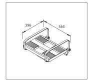
**GP 4000** Die besonders flache Bauweise mit großen Gummiauflageflächen und zwei Spanngurten bietet beste Einsatzmöglichkeiten. Der Verstellwinkel beträgt  $\pm$  12°.
